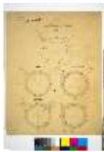
LIIMus.IV, Treppenturm, nördl., Schichtengrundrisse, Neusch., DI031082, BSV-
