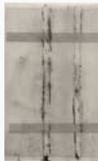
Abb. 3: Röntgenaufnahme. Man sieht die zwei Fugen der drei miteinander verleimten Tafeln.
